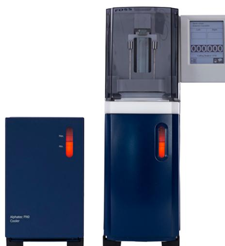
La méthode dite de l'indice de chute est reconnue par les organismes internationaux tels que l'ICC, l'AACC, l'ISO et l'ASBC dans les normes suivantes : AACC 56-81B (1972), ISO ISO/DIS 3093 (2009) et ASBC Barley 12-A.
