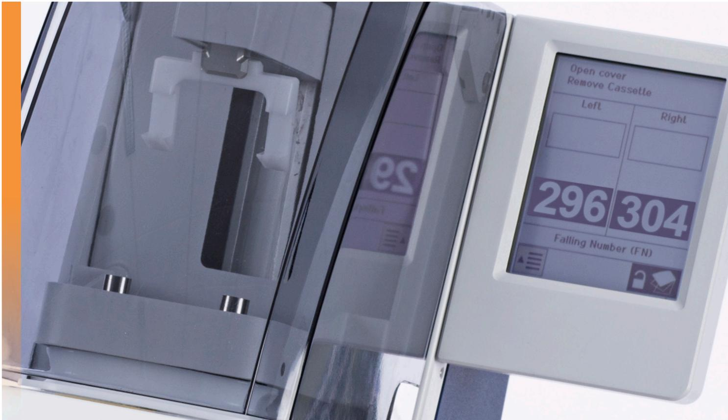
L'Alphatec™ FN<sup>o</sup> offre un moyen sûr et moderne d'effectuer le test d'indice de chute utilisé pour déterminer les dommages causés par la germination des grains et l'activité enzymatique des farines avant leur utilisation en boulangerie, en malterie, etc.
